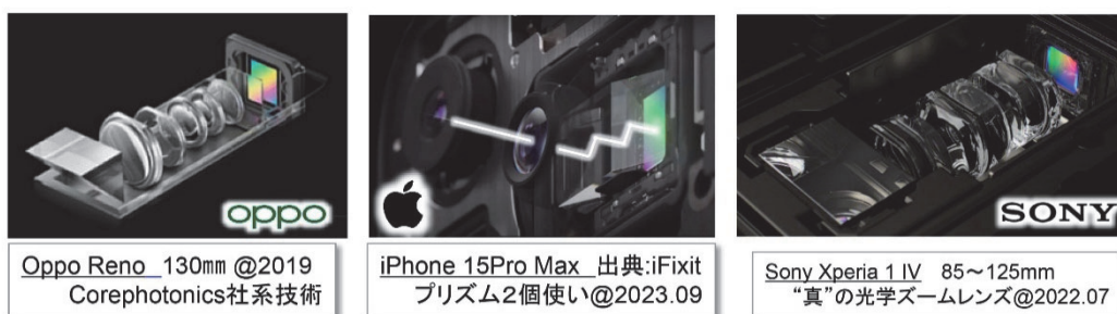
図 B-1 ペリスコープ型 図 B-2 第二の反射鏡付き 図 B-3 《真のズームレンズ》
