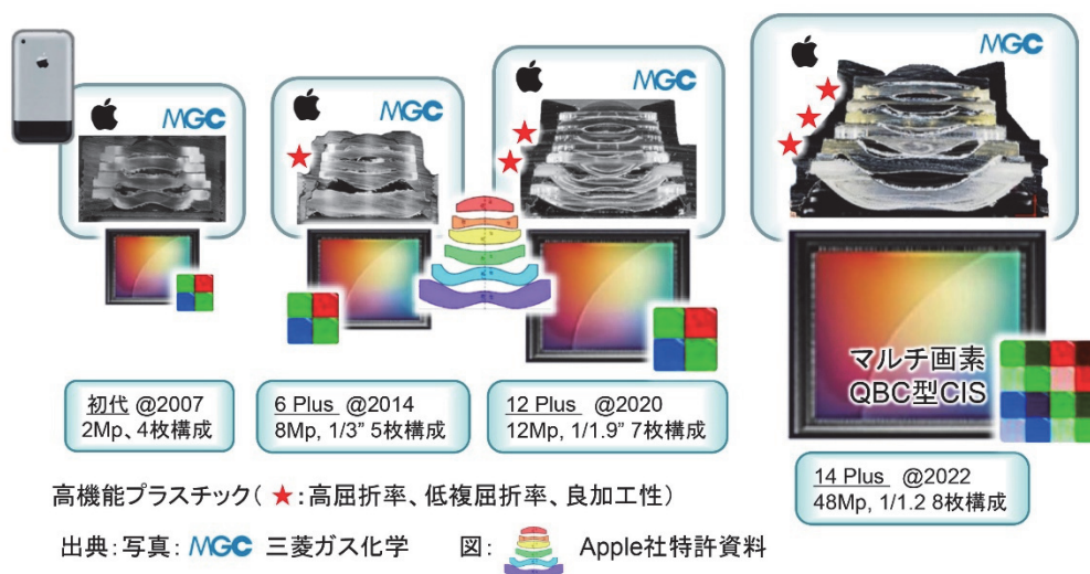
図5 iPhone 主カメラ広角非球面レンズと CIS サイズの変遷
