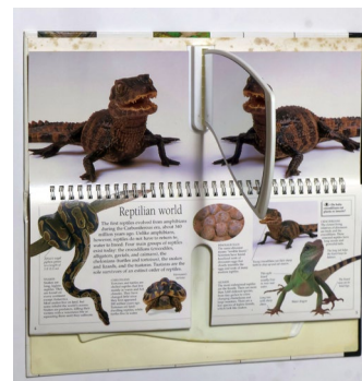
図 4 平面鏡を組み付けステレオ写真を観賞する状態
